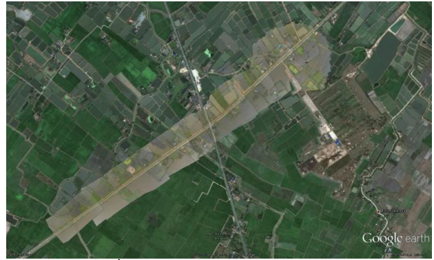
รูปที่ 19 ผลลัพธ์จากการต่อภาพถ่ายจาก UAV
